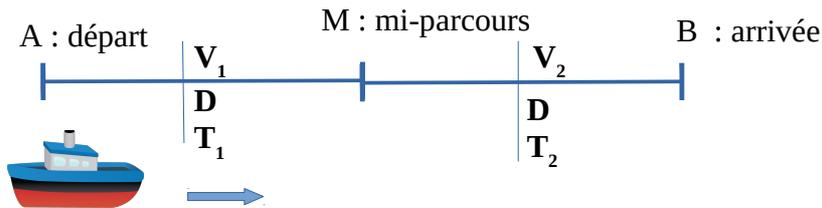
Sur le parcours AM : Vitesse  $V_1$  , distance  $D$  , temps  $T_1$
